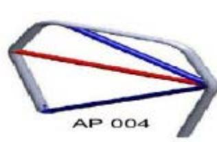
Στο σχέδιο AP004 υπάρχει η κόκκινη σωλήνα (40 mm διάμετρος x 2 mm πάχος) η οποία θεωρείται ως μέρος του πλαισίου, στην οποία περίπτωση δεν μπορεί να τοποθετηθεί η μπλε σωλήνα από κάτω.
