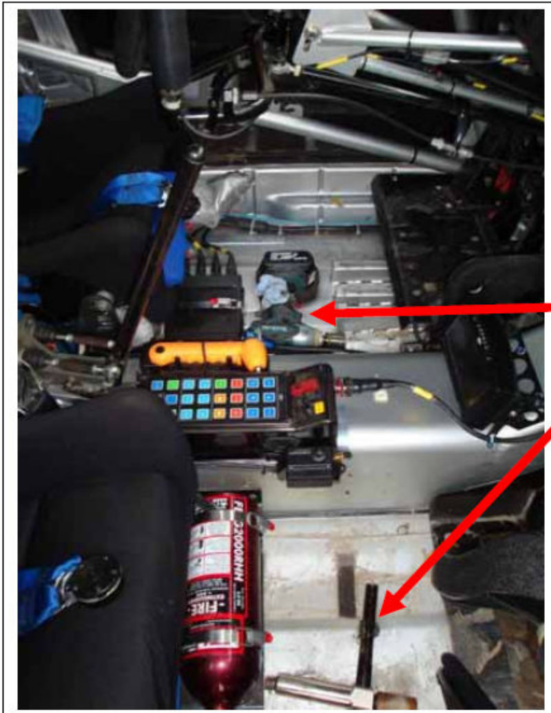
Εικόνα 42: Λανθασμένη τοποθέτηση εργαλείων μπροστά από το πλήρωμα
