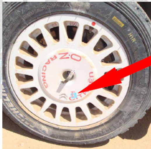
Εικόνα 61: Λάθος μαρκάρισμα πάνω σε αφαιρούμενο πλαστικό προστατευτικό
