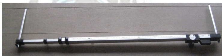
Εικόνα 24: Πτυσσόμενη ράβδος – μετροταινία
