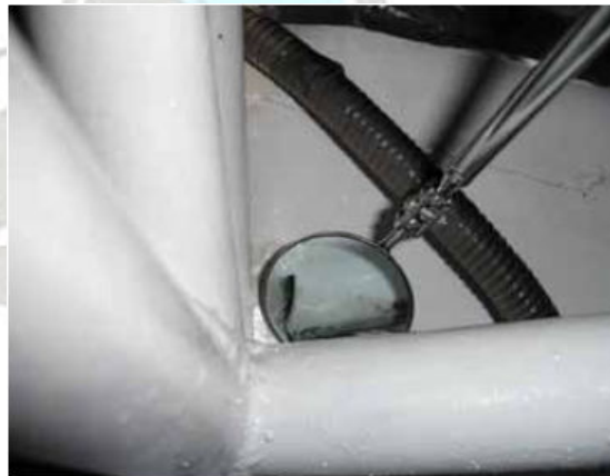
Εικόνα 28: Λανθασμένες κολλήσεις κλωβού ασφαλείας
