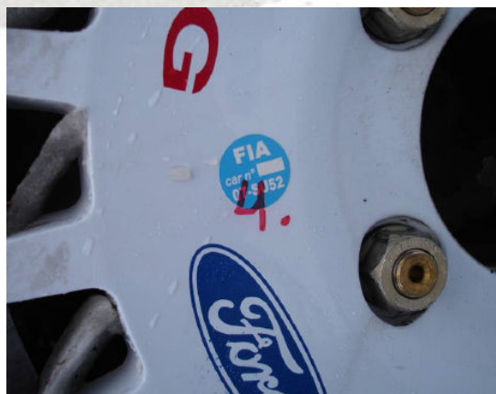
Εικόνα 66: Μαρκάρισμα ελαστικών με ειδικό αυτοκόλλητο FIA
