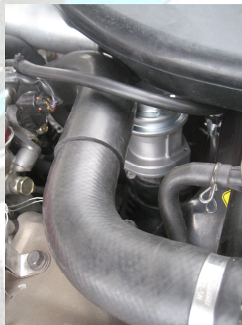
Εικόνα 75: Λανθασμένη τοποθέτηση βαλβίδας bypass Evo IX
