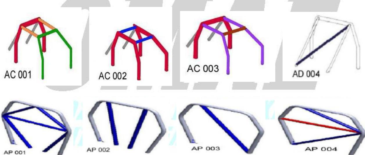
Στο σχέδιο AP004 υπάρχει η κόκκινη σωλήνα (30 mm διάμετρος x 2 mm πάχος) η οποία θεωρείται ως μέρος του πλαισίου, στην οποία περίπτωση δεν μπορεί να τοποθετηθεί η μπλε σωλήνα από κάτω.
