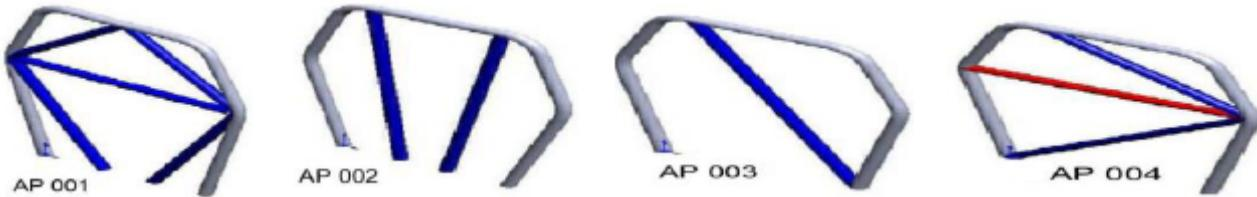
Στο σχέδιο AP004 υπάρχει η κόκκινη σωλήνα (30 mm διάμετρος x 2 mm πάχος) η οποία θεωρείται ως μέρος του πλαισίου, στην οποία περίπτωση δεν μπορεί να τοποθετηθεί η μπλε σωλήνα από κάτω.
