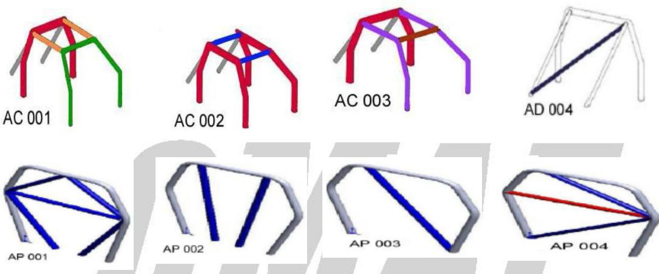
Στο σχέδιο AP004 υπάρχει η κόκκινη σωλήνα (30 mm διάμετρος x 2 mm πάχος) η οποία θεωρείται ως μέρος του πλαισίου, στην οποία περίπτωση δεν μπορεί να τοποθετηθεί η μπλε σωλήνα από κάτω.
